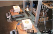
路面低減温度に係る室内照射試験
