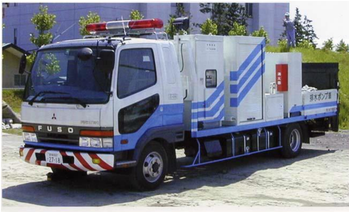
国交省で配備している排水ポンプ車
