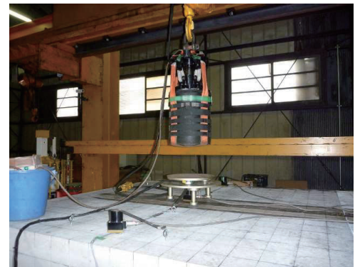
写真-9 重錘落下たわみ測定状況
