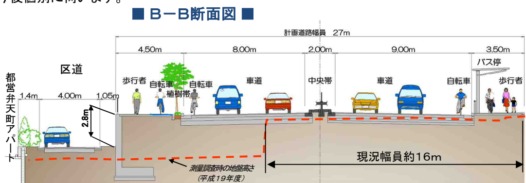
図3 道路整備イメージ(平面図及び断面図)
