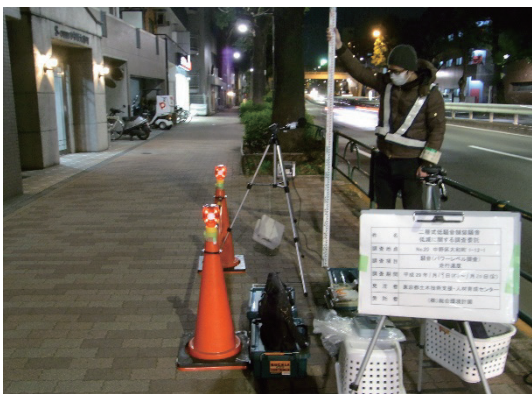
写真-2 自動車走行騒音の測定状況 (例)
