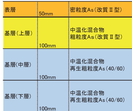
図-24 試験施工区間舗装断面図
