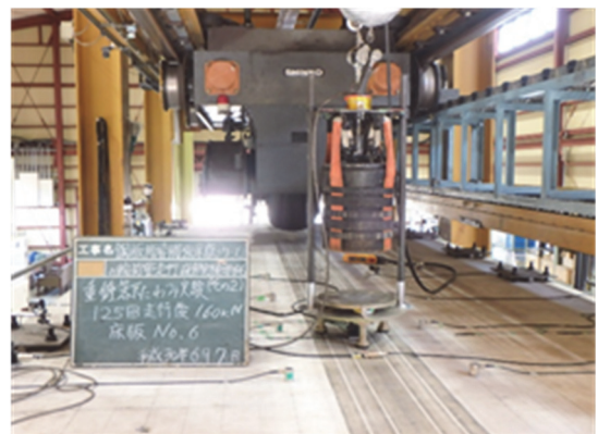
写真-7 重錘落下たわみ試験機
