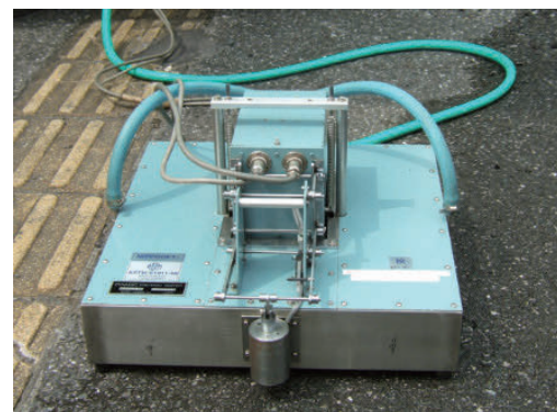
写真-2 DFテストの外観
