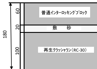
インターロッキング舗装(非透水性)
