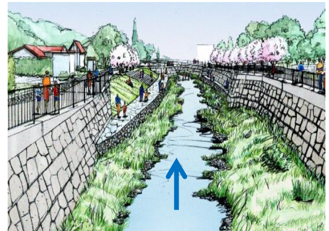
親水護岸整備（無量寺橋下流）
