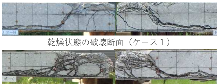
水張状態の破壊断面（ケース2）
