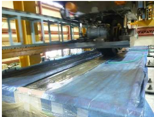
輪荷重走行疲労試験（水張条件）
