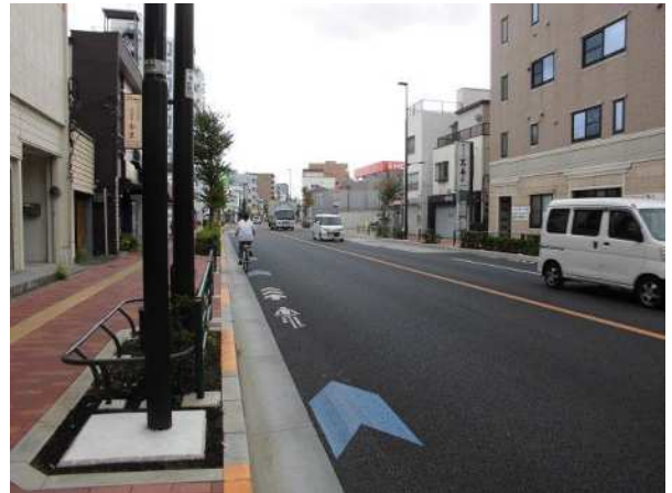
車道混在 平和橋通り（江戸川区）
