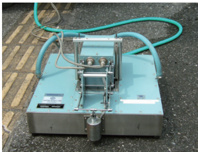
写真-2 DFテストの外観
