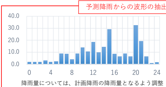
アンサンブル将来予測降雨波形の抽出方法のイメージ
