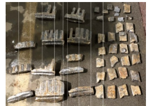
写真-2 ビット損傷状況
