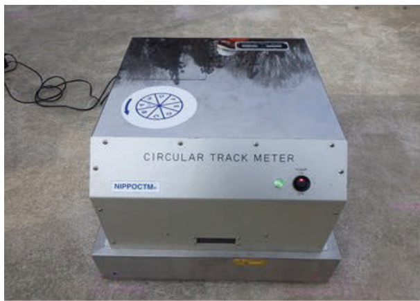
写真-4 回転式きめ深さ測定装置（CTメータ）
