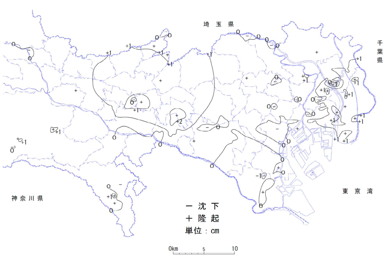
図-3 最近5年間の地盤変動量図（平成29年～令和3年）
