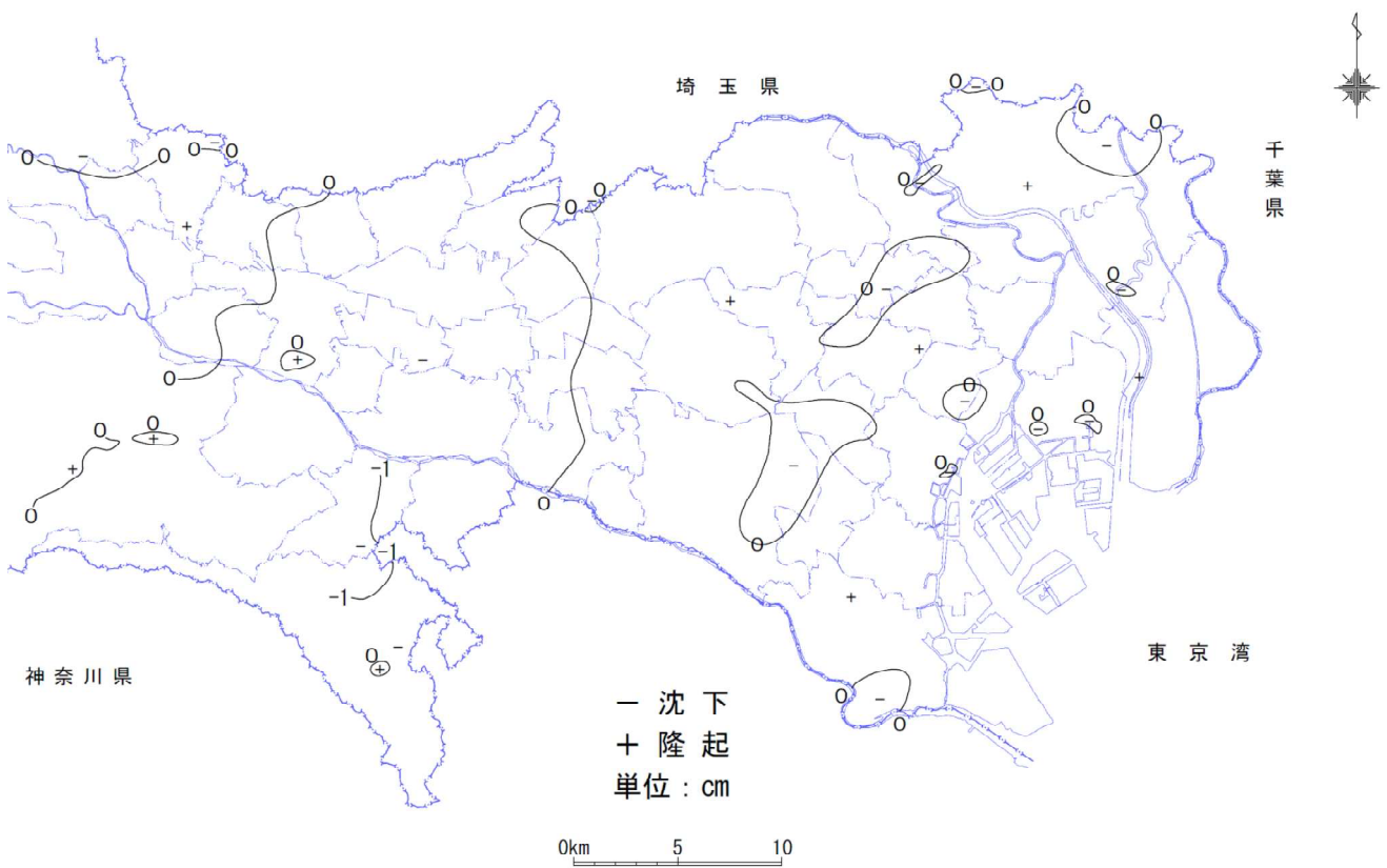
図-2 令和3年の地盤変動量図
