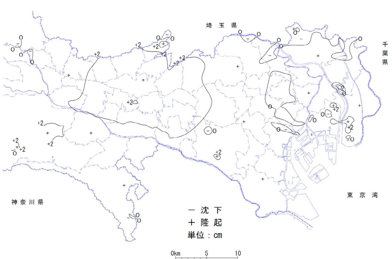
図-4 最近10年間の地盤変動量図（平成24年～令和3年）
