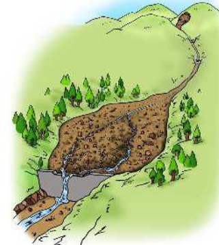
砂防堰堤が土石流をとめるようす
