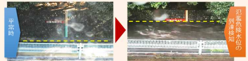
AI等を用いた河川監視カメラの自動解析のイメージ
