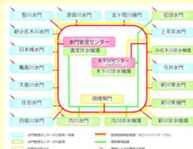
水門管理施設の通信回線のダブルループ化
