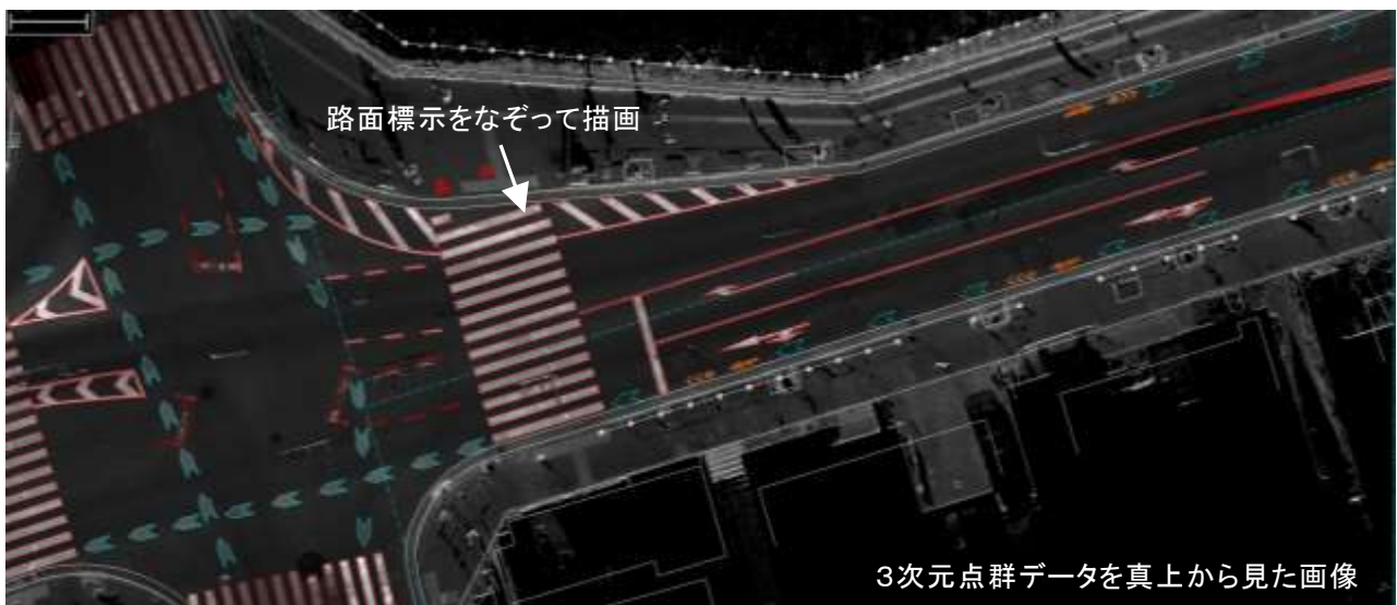
図－1 3次元点群データを活用した平面図作成の作業状況
