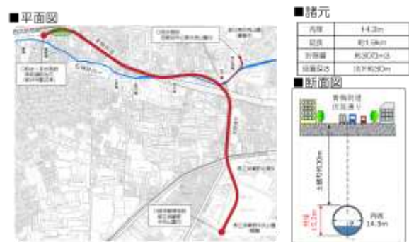
図1 石神井川上流地下調節池
