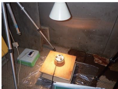
写真-3 照射ランプの高さ設定の様子
