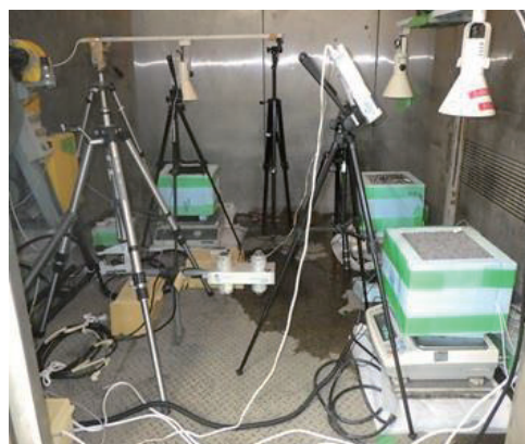
写真-1 測定機器配置状況（例 散水照射試験）
