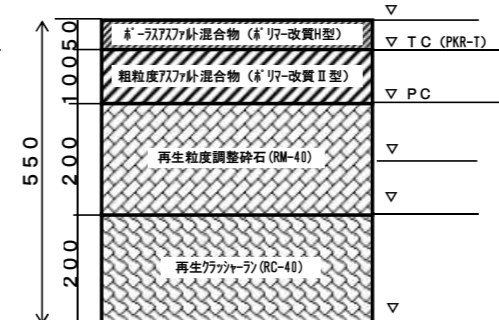
車道 アスファルトコンクリート舗装 （低騒音・55型）
