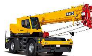
⑦25tラフタークレーン
