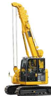
⑩4.9tクローラークレーン
