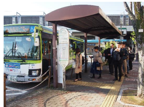
写真4.12.5 高木を避けて配置された視覚障害者誘導用ブロック上のバス利用者
