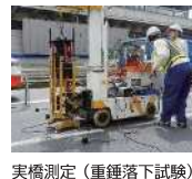
実橋測定（重錘落下試験）
