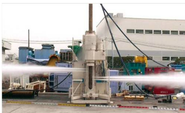
写真1.1 ツインノズルによる気中噴射状況
