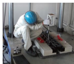
写真-2 軸力測定試験
