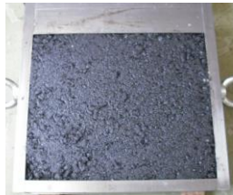
写真-4 直線形状供試体
