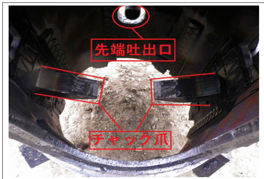
写真-2 ケーシング先端部（チャック爪&吐出口）
