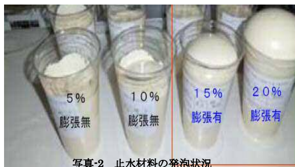
写真-2 止水材料の発泡状況
