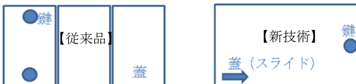
【図4：横断柵用蓋（60×120cm）の開閉工数比較】
