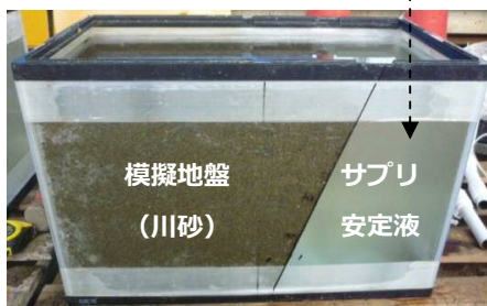
サプリ安定液の孔壁安定性 (拡底杭を模擬した試験)
