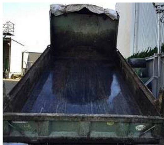
写真-1 ダンプ荷台への散布例
