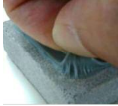
写真-3 粘着力の発現状態
