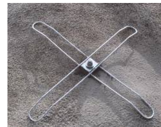
写真-1 フレームワッシャー設置状況
