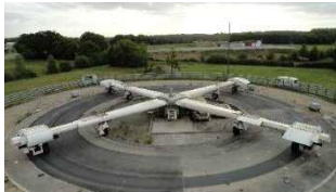
写真3：フルスケール輪荷重試験機
