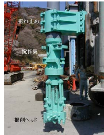
写真－３ 縮小時の攪拌混合部
