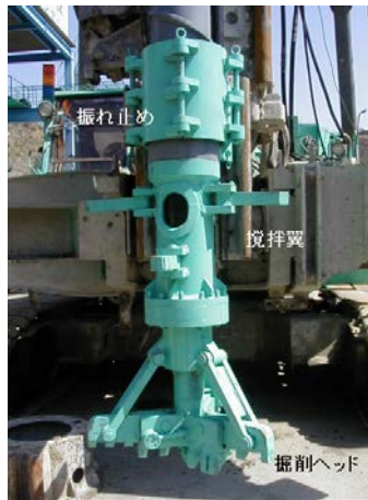
写真－２ 拡大時の攪拌混合部
