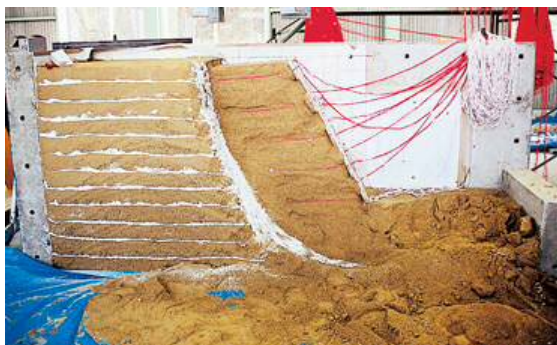
写真：補強材+表面保護パネル) の破壊後の様子
