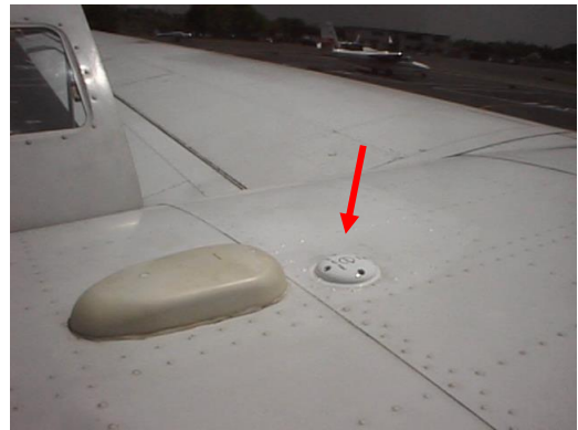
航空機の上部に設置されたGPSアンテナ
