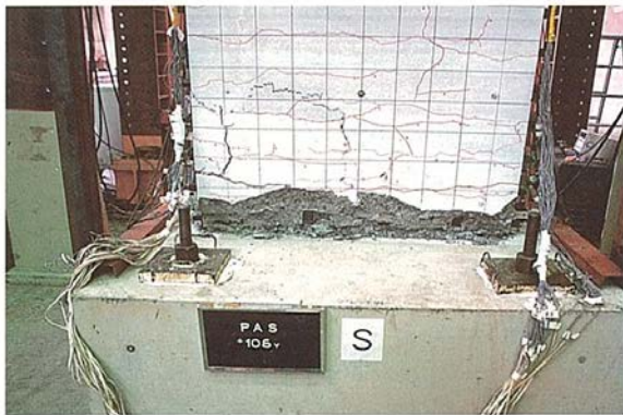
Head-barの場合 106y時の損害状況 (8y:主鉄筋降伏時の変位) 定着が健全であり、コアコンクリートの損傷や主鉄筋の座屈程度が軽く、部材耐力の低下が少ない。せん断補強鉄筋の降伏後に被りコンクリートが剥落。
