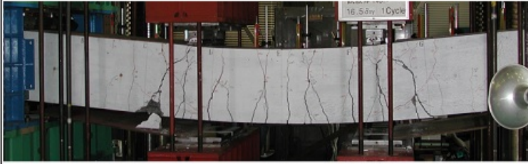
梁の曲げ試験の破壊状況(半円形フック)
