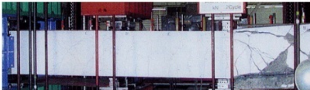
(a) せん断補強鉄筋なし(確認試験体)
