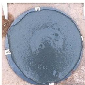
新工法のシリンダーフロー
