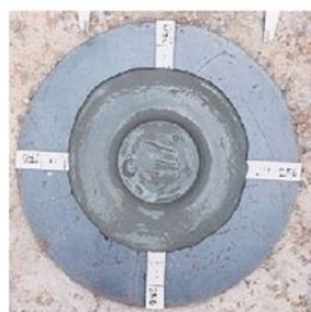
従来工法のシリンダーフロー
