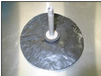
加圧調整パイプ取付状況
