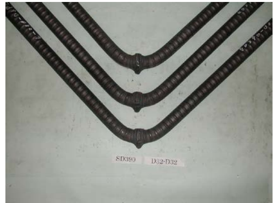
写真-2 曲げ試験 (SD390、D32)
