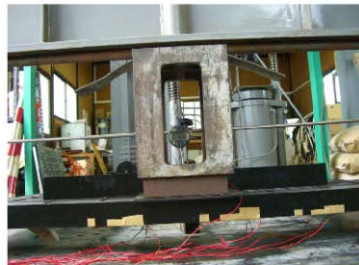
残留たわみ測定 残留たわみ: 0.1mm
