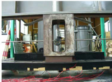
変位測定 荷重: 58.3kN 変位: 4.64mm
