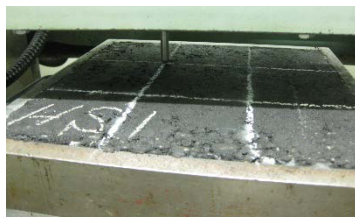
静荷重載荷試験状況
